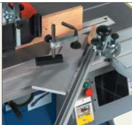
Der Anschlag mit Klemmung für sicheren Halt.
